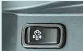
Schalter zur Regeneration des DPF (Dieselpartikelfilter)
