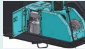
Einfache Filtration 3 x Hydraulikölfilter
