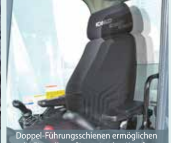
Doppel-Führungsschienen ermöglichen die Einstellung für optimalen Komfort
